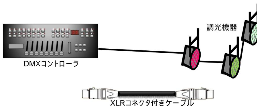
DMXケーブルには標準で使用される5ピンタイプのXLRコネクタに適用されます。また、ご用途に応じ2ペアケーブルと1ペアケーブルの2種類を用意しております。
